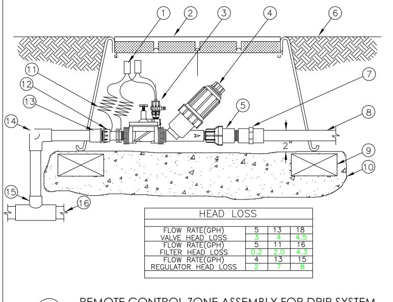
REMOTE CONTROL ZONE ASSEMBLY FOR DRIP SYSTEM
